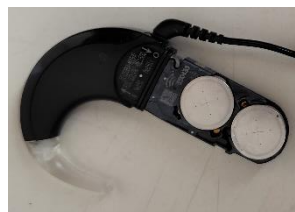
メドエル社 SONNET2 空気亜鉛電池を使用した際の 現物写真
